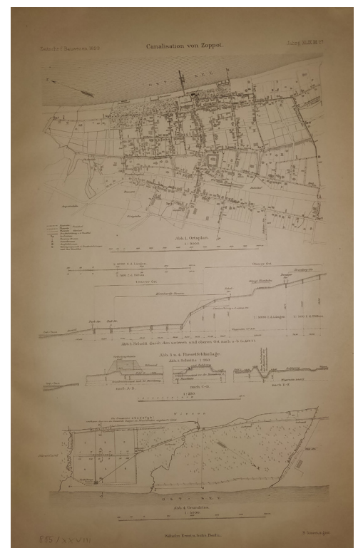
885. SOPOT. Schematy systemu kanalizacyjnego, 1899.
